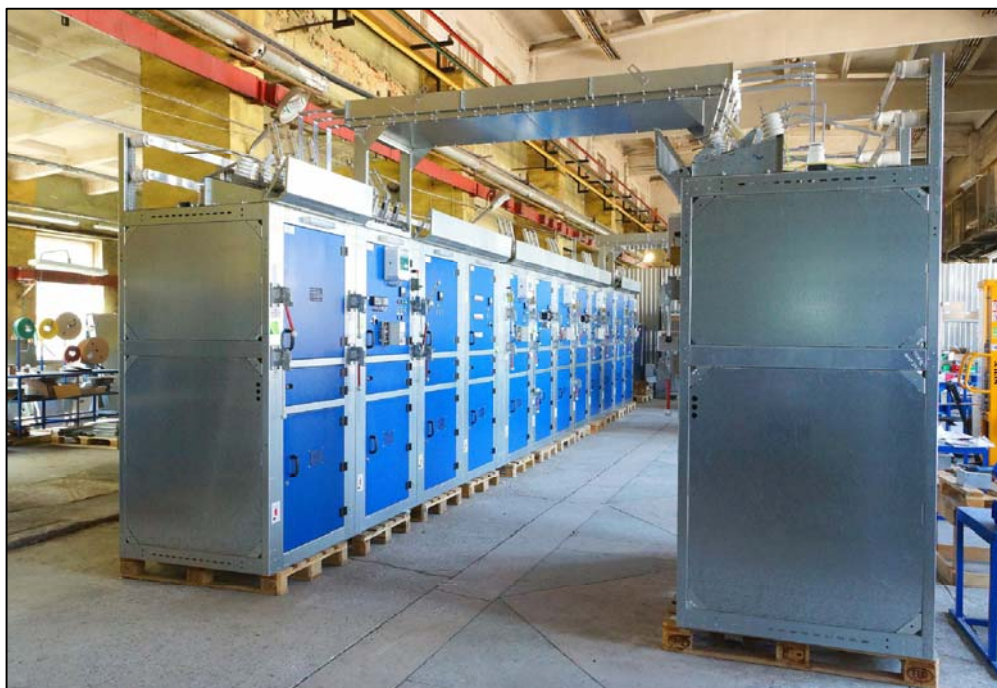
Камеры КСО393 с вакуумным выключателем – однорядное исполнение
